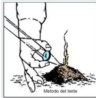
Este sistema puede ser el más recurrido y fácil, siempre que cuentes con un cristal que tenga aumento, ya que al pasar los rayos del sol por él produce una luz concentrada y de alta temperatura. Pueden utilizarse los lentes ópticos, una lupa o los cristales de los lentes de larga vista o prismáticos. También sirve el fondo de una botella de cristal ya que el vidrio en esa zona es grueso y concentra más luz solar. Cuidado con dejarlo abandonado puede producir un incendio.
